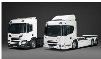
SCANIA , porteur 165-300kWh 250km d'autonomie
