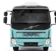
VOLVO TRUCKS , 27t porteur 200-300 kWh 200km d'autonomie
